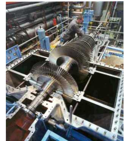
800 kW el Dampfturbinenrotor (P. Brotherhood Ltd.)
